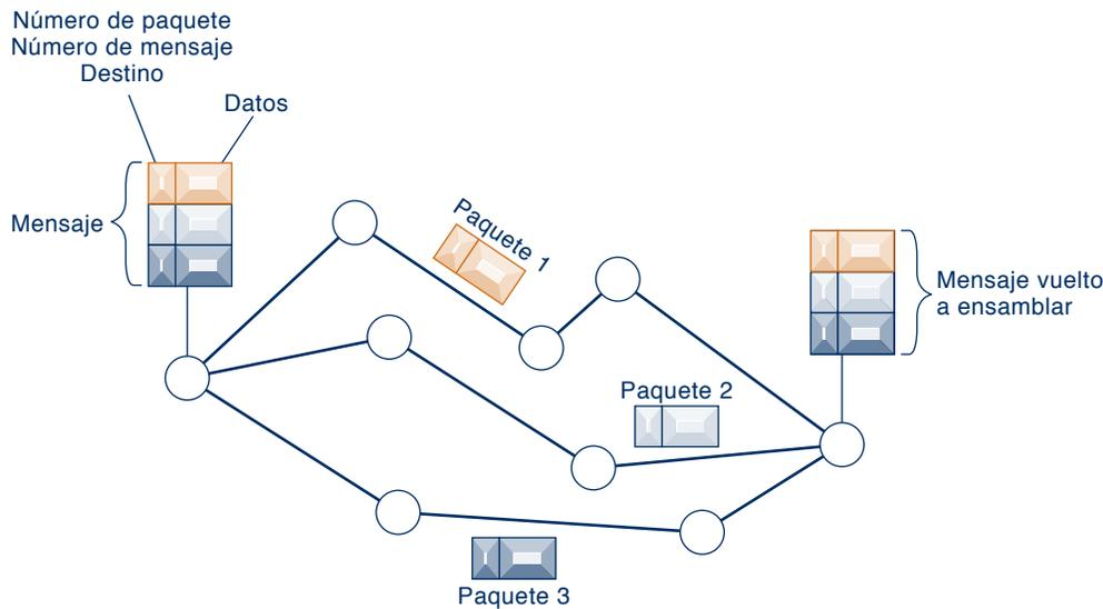
Los datos se agrupan en pequeños paquetes, los cuales se transmiten de manera independiente a través de varios canales de comunicación y se vuelven a ensamblar en su destino final.
