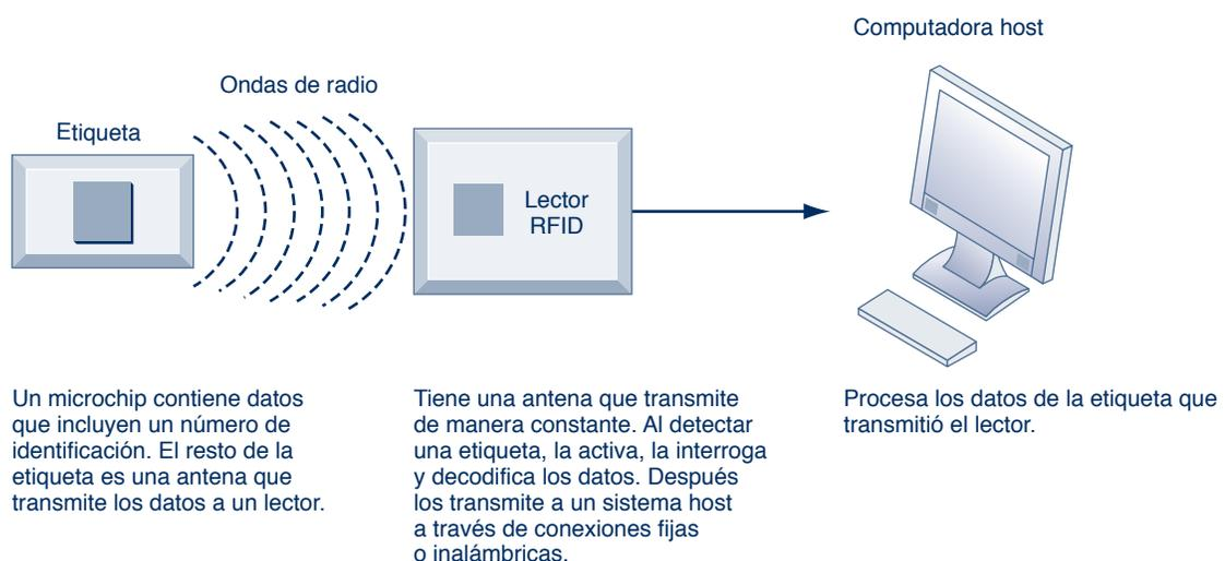
RFID utiliza transmisores de radio que consumen poca energía para leer los datos almacenados en una etiqueta, a distancias que varían desde 1 pulgada hasta 100 pies. El lector captura los datos de la etiqueta y los envía a través de una red hacia una computadora host para que los procese.
