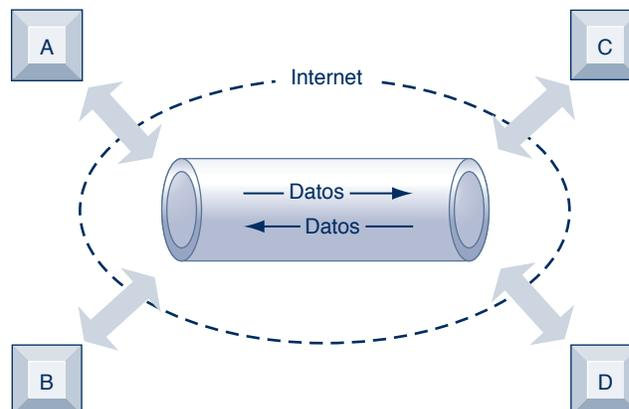
La VPN es una red privada de computadoras vinculadas mediante una conexión de "túnel" segura a través de Internet. Protege los datos que se transmiten a través de la red Internet pública al codificarlos y "envolverlos" dentro del Protocolo de Internet (IP). Al agregar una envoltura alrededor de un mensaje de red para ocultar su contenido, las organizaciones pueden crear una conexión privada que viaja a través de la red Internet pública.
