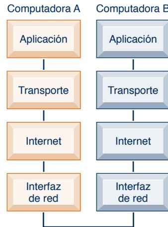
Esta figura ilustra las cuatro capas del modelo de referencia TCP/IP para las comunicaciones.
