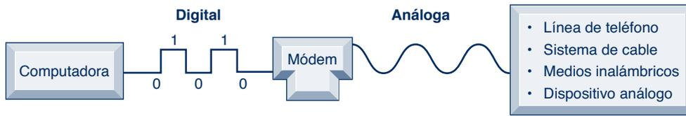
Un módem es un dispositivo que transfiere señales digitales en forma analógica (y a la inversa) de manera que las computadoras puedan transmitir datos en redes analógicas como las de teléfono y de cable.
