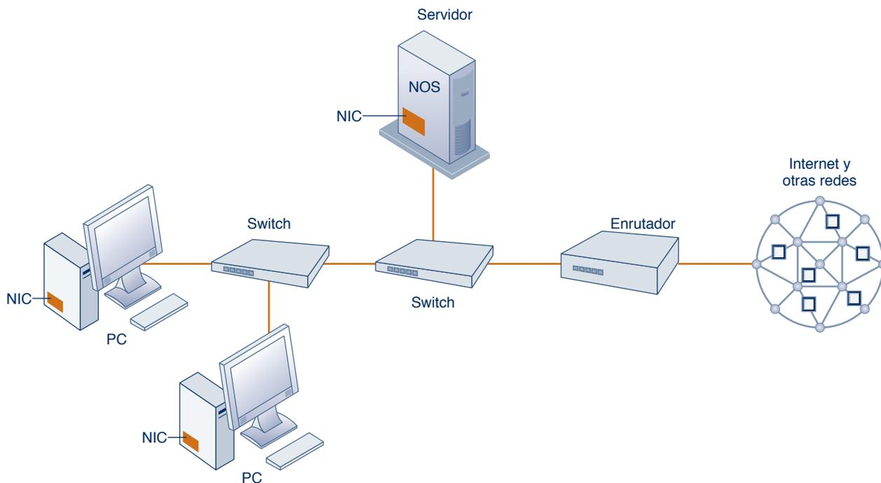
Aquí se ilustra una red de computadoras muy simple, la cual consiste en computadoras, un sistema operativo de red que reside en una computadora servidor dedicada, cable para conectar los dispositivos, tarjetas de interfaz de red (NICs), switches y un enrutador.
