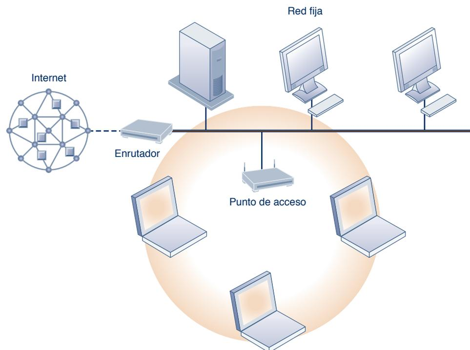
Las computadoras laptop móviles equipadas con tarjetas de interfaz de red se enlazan a la LAN fija al comunicarse con el punto de acceso. Este punto de acceso usa ondas de radio para transmitir las señales de la red fija a los adaptadores cliente, que convierten estas ondas de radio en datos que el dispositivo móvil pueda comprender. Después el adaptador cliente transmite los datos del dispositivo móvil de vuelta al punto de acceso, quien los reenvía a la red fija.
